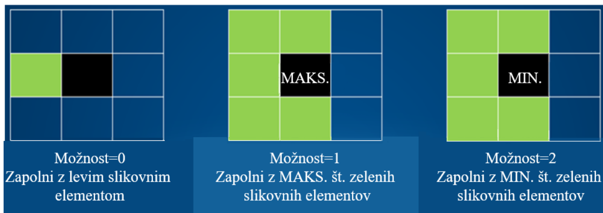
Slika 54. Uporaba algoritma polnjenja lukenj z uporabo bloka za obdelavo diskretnih lukenj ima tri možnosti za polnjenje.
