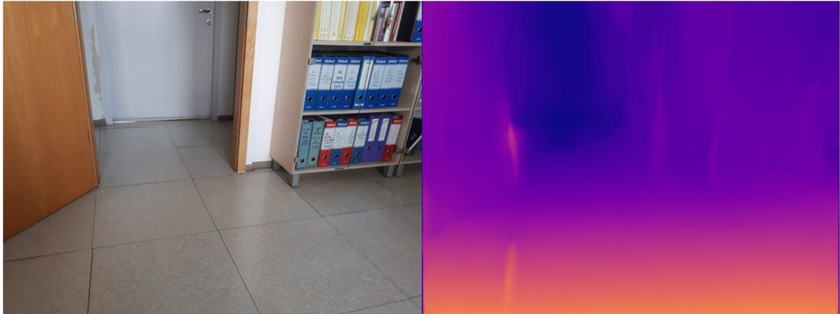
Slika 55. Primer 1: Globinska slika iz posamičnega prizora pridobljena z nevronske mrežo monodepth
